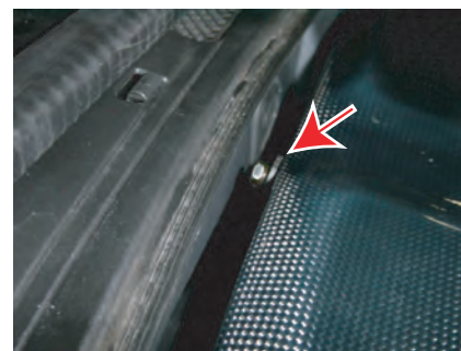
7: カーボンケースASSYをエンジンルームに配置して、エアフロメーターのカプラーを取り付けます。エアフロメーターを下へ押し込んで、しっかりはめてからビスCで固定。 ※ウエザーストリップは元に戻します。
