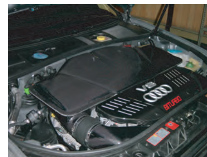
11: カーボンケースにノーマルのジャバラホースを取り付け、その先に付属のカーボン導入ダクト左右を取り付けます。ビスBとナットを使用して取り付けます。
