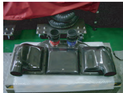
1: エアフロメーターをカーボンケース裏側にラバーホースで取り付けます。
