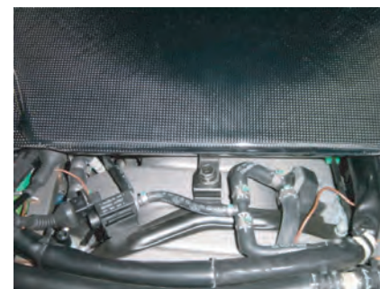
8: カーボンケースの前側ステーAをビスDで固定します。
