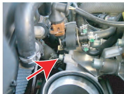
4: ステーBの取り付け位置 ステーの取り付けはビスCを使用します。
