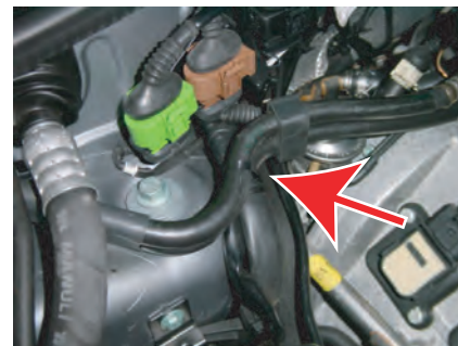
2: フューエルラインをカーボンケースから逃がすようにタイラップで固定します。それからカーボンケースを取り付けます。※クリアランスに十分注意してください。
