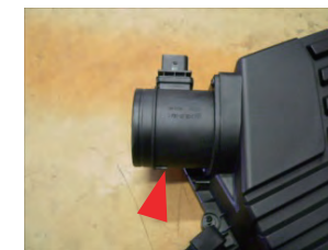
10. クリーナーケースからエアマスセンサーを取り外します。(TTRSはセンサーでは無くパイプになります)
