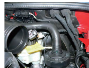
8. エアマスセンサーのカブラー配線を伸ばすためにテープを剥がし、配線を分け、コルゲートチューブで巻きタイラップで固定します。
