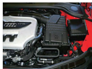
6. クリーナーケースを上下に分けて取り外します。(固定しているブラケットが外しづらい為)
