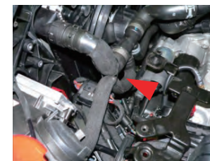
9. カーボンフィルターケースとの干渉を防ぐためにラジエーターホースをタイラップで固定します。
