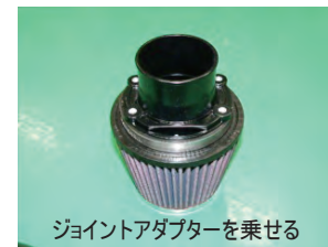
12. アダプターにフィルターを取り付け、その上にジョイントアダプターを乗せます。
