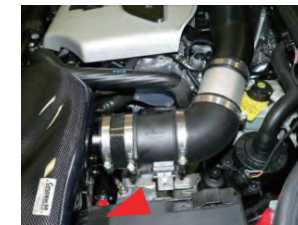
17. ヒューズBOX手前にあるブラケットを固定していた孔にステーを仮組みし、カーボンフィルターケースASSYを入れます。
