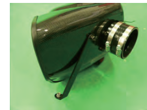
17. ヒューズBOX手前にあるブラケットを固定していた孔にステーを仮組みし、カーボンフィルターケースASSYを入れます。
