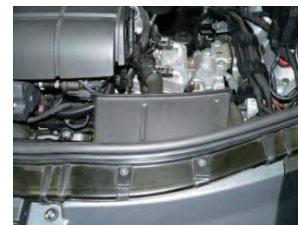
15. 導入ダクトの先端部だけを元の通りに戻します。
