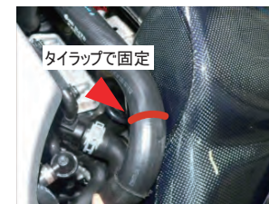
19. カーボンフィルターケースのタイラップを通した部分にラバーホースを固定します。
