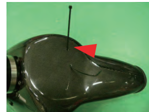
11. 最終的に装着してからラバーホースを固定するため、予めタイラップを通しておきます。
