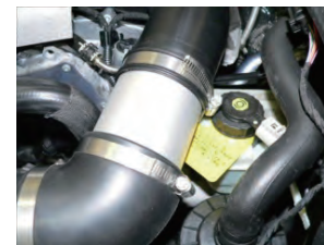
16. インテークホースに付属のバンドを使用し、アルミパイプ、エルボウホース、外したエアマスセンサーを取り付けます。 ※TTRSは、下記参照
