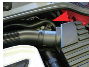
4. エアマスセンサーのカブラーを外します。(TTRSはセンサーでは無く、樹脂パイプになります)
