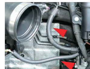
8. エアマスセンサーのカブラー配線を伸ばすためにテープを剥がし、配線を分け、コルゲートチューブで巻きタイラップで固定します。
