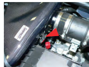
18. エアマスセンサーとジョイントアダプターをホースで繋ぎます。次にカーボンフィルターケースをステーで固定し、ボディー側も本締めします。
