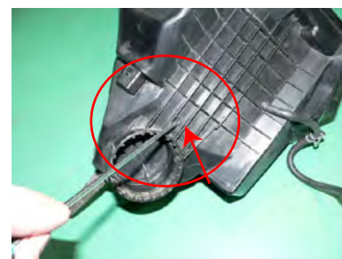
ボックス内にある、二次吸気バルブASSYを外します。ロックピンを押しながら少しずつスライドさせます。
