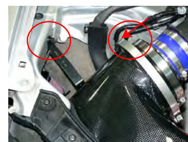
ボディにステーで固定します。矢印部のホースとバンドが干渉するので、バンドカバーで保護してください。
