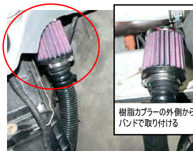
フィルターに付属オイル塗布します。エアポンプホースにフィルターを差し込み、バンドで取付けます。フェンダー側の奥側にタイラップで留めます。
