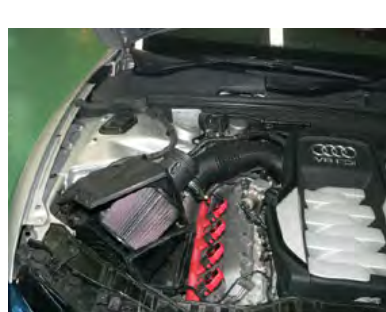
ノーマルクリーナーボックス上側をエアマスセンサーごと外します。
