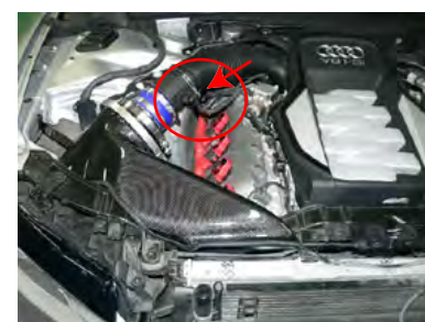
クリーナーASSYをサクシオンホースに取り付けて、配置します。エアマスセンサーのカプラーを接続します。
