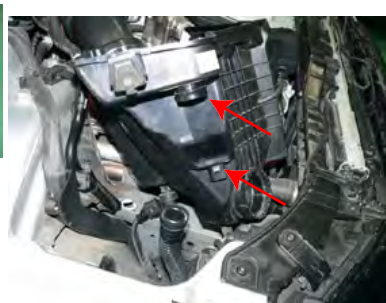
ボックス下側に付いているエアポンプのホースと、二次吸気バルブ用カバーを取り外します。(手が入りずらく、外し難い)
