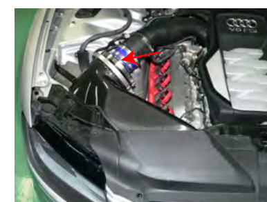
ノーマルのパネルを元の通りに取り付けます。 ※バンドとボンネットが当たらないか確認して十分注意してボンネットを閉めてください。必要に応じてクッションテープをご使用ください。
