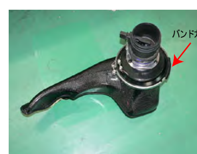
アダプターとクリーナーASSYを組み立てます。アダプターの向きは写真のようにします。
