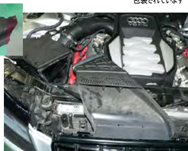
導入ダクトを外します。
