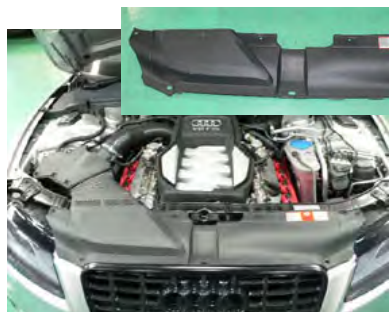
ラジエター上部のパネルを外します。
