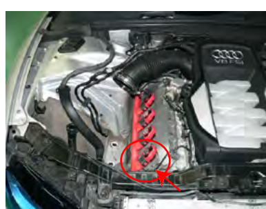
ノーマルクリーナーボックス下側を外します。φ4ホースを抜いたパイプに付属φ4キャップで栓をします。
