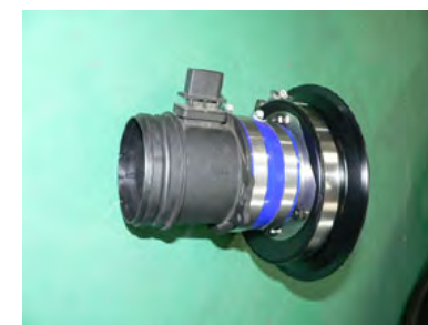
アダプター、ジョイントアダプター、ラバーホースをエアマスセンサーに組み付けます。
