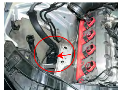
外した二次吸気バルブASSYを配線カプラーに接続し、下の方にタイラップで留めます。
