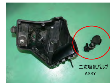
二次吸気バルブASSYを外したら、それを車両側の配線に元の通り接続させます。
