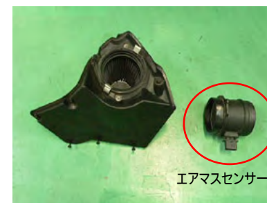
ノーマルクリーナーケースからエアマスセンサーを外します。
