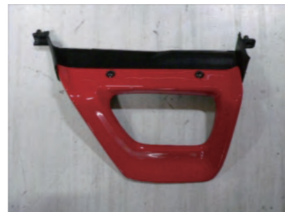
5. 導入ガイドにビスBとM6ナットでファイバー導入ガイドを取り付けます。
