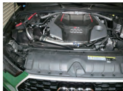
16. ラジエーターパネルとレバーを元の通りに戻して作業完了です。
