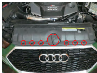
1. レバーとクリップ6箇所を外して、ラジエーターパネルを外します。
