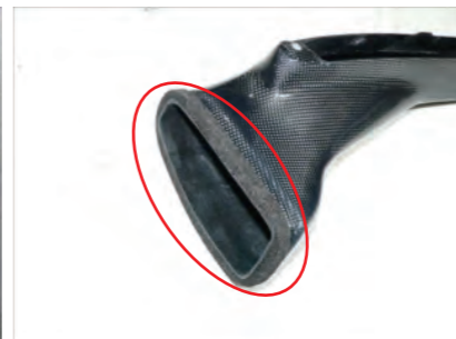
6. カーボン導入ダクトにパッキングテープを一周貼り付けます。
