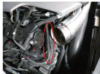
8. 配線にコルゲートチューブを取り付けます。
