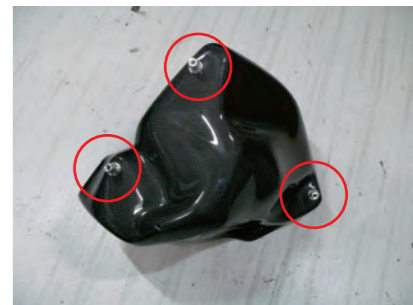
7. カーボンボックスにアルミスタッドをビスAで取り付けます。
