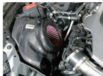
11. カーボンボックスにフィルターを配置します。
