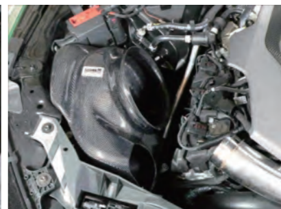
9. アルミスタッドを車両のゴム部に差し込み、カーボンボックスを配置します。
