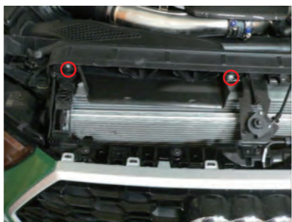
2. ボルトを2箇所を外して、導入ガイドを外します。
