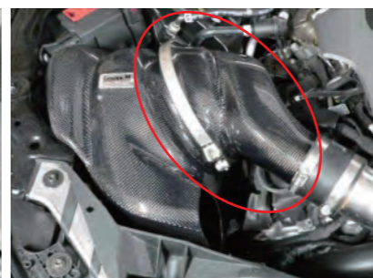
12. カーボンダクトを配置してVクランプで固定します。
